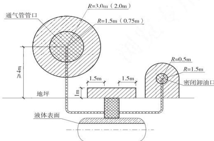
图 C.0.3 汽油埋地卧式油罐的爆炸危险区域划分
