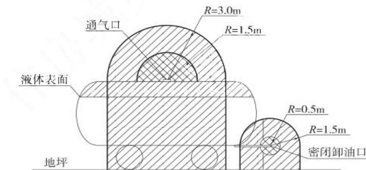
图 C.0.4 汽油油罐车的爆炸危险区域划分
